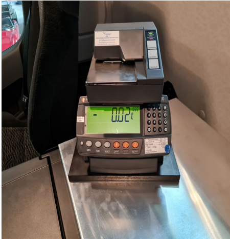
Wägeelektronik mit Drucker
